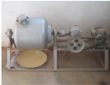
Photo 3 : Broyeur à boulets et série de tamis
