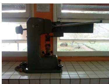
Photo 9 : Appareil d'essais de flexion
