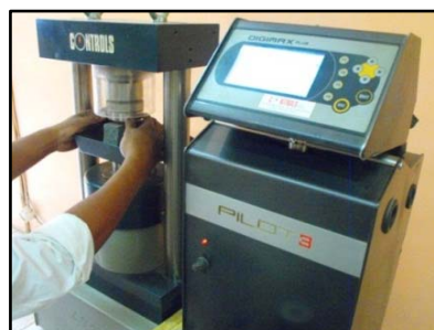
Photo 10 : Appareil de mesure de la résistance à la compression
