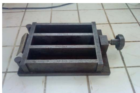
Photo 6 : Moule pour éprouvette 4*4*16[cm]
