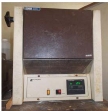
Photo 4 : Four électrique de calcination à température réglable
